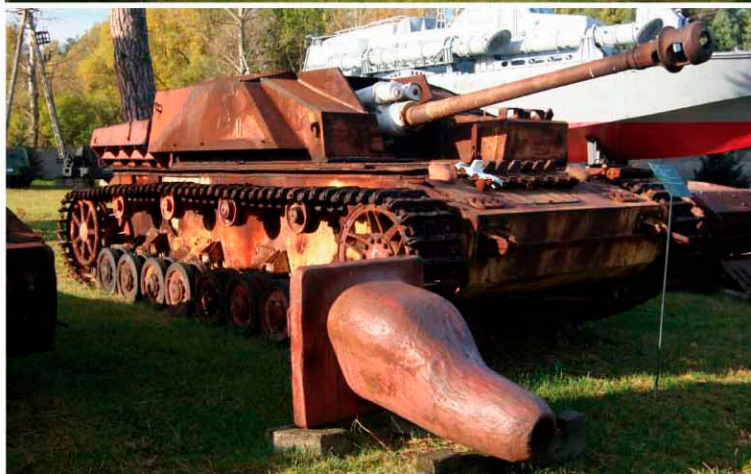
修復中のIV号突撃砲。手前に外したザウコフ防盾が置いてある。
